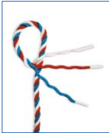
2. Nach dem Festlegen der gewünschten Aug-Größe die mittlere oben liegende Litze auf dieser Höhe mittels Spleißnadel durchziehen.
