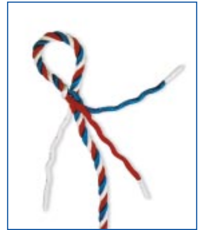
3. Danach die nächste oben liegende Litze ebenso durchziehen – hilfreich ist es, das Seil vorher etwas zu sich zu drehen. Als nächstes die übriggebliebene Litze ebenso wie die beiden anderen unter die verbleibende Litze spleißen.
