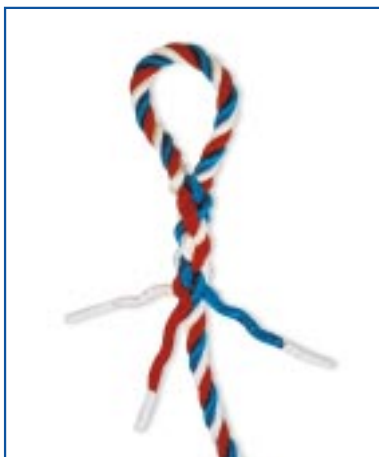
4. In weiterer Folge wird jede Litze über die nächste fixe Litze gespleißt, jede der drei anfänglich aufgedrehten Litzen wird so – nacheinander – mindestens dreimal verspleißt.
